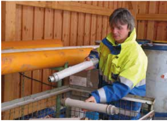
03 Abgeschaltete NH- und HH-Sicherungseinsätze lassen sich effektiv recyceln
